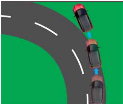
Bei Fahrzeugen mit CBC-Funktion wird bei der Untersteuerung der Bremsdruck auf der Vorderachse reduziert.
