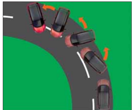
Bei Fahrzeugen mit CBC-Funktion wird bei der Übersteuerung der Bremsdruck auf die Innenräder in der Kurve reduziert.
